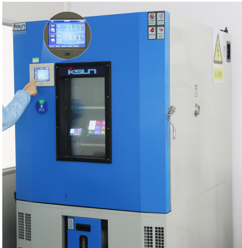
图 4-7 高低温老化测试图
