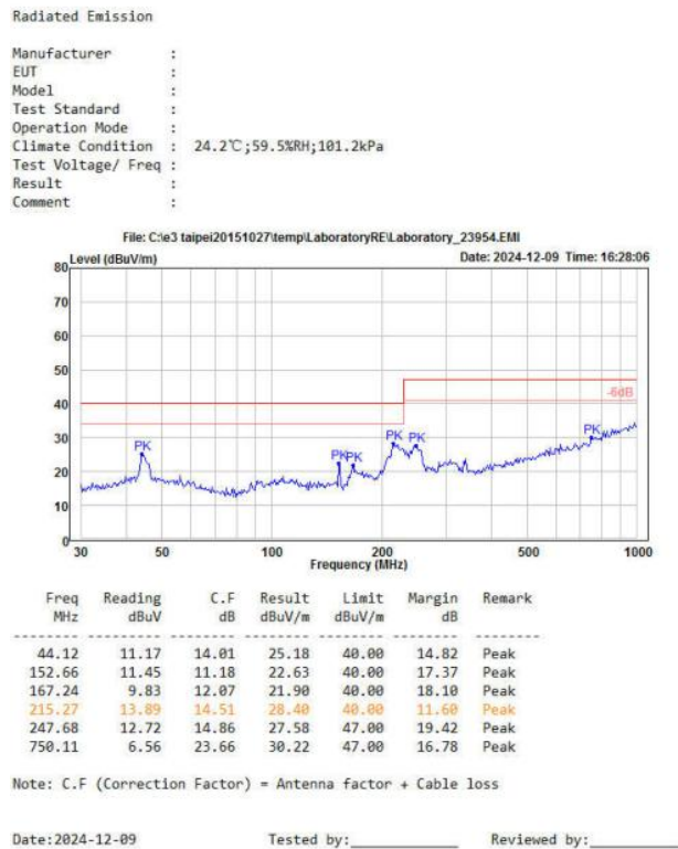
图 4-5 RE 测试水平方向
